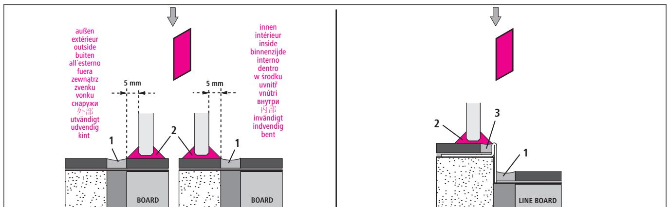
**1 Wartungsfuge** / Joint de maintenance / Maintenance joint / Voegnaad / Fughe di manutenzione
